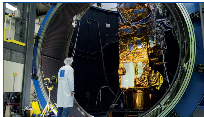
Metop-C dans le large space simulator de l'ESTEC, crédit ESA-G.Porter
